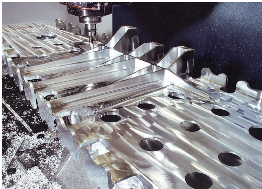
Fig. 2 Esempio di una lavorazione di un componente in alluminio (Jobs).
